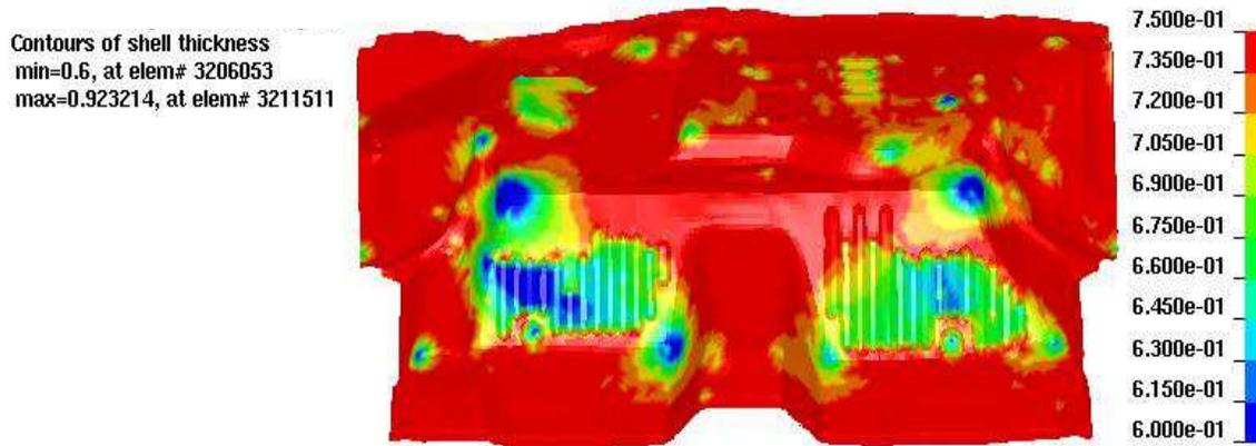
*Blank thickness ( $t_0=0.75\text{mm}$ )*
